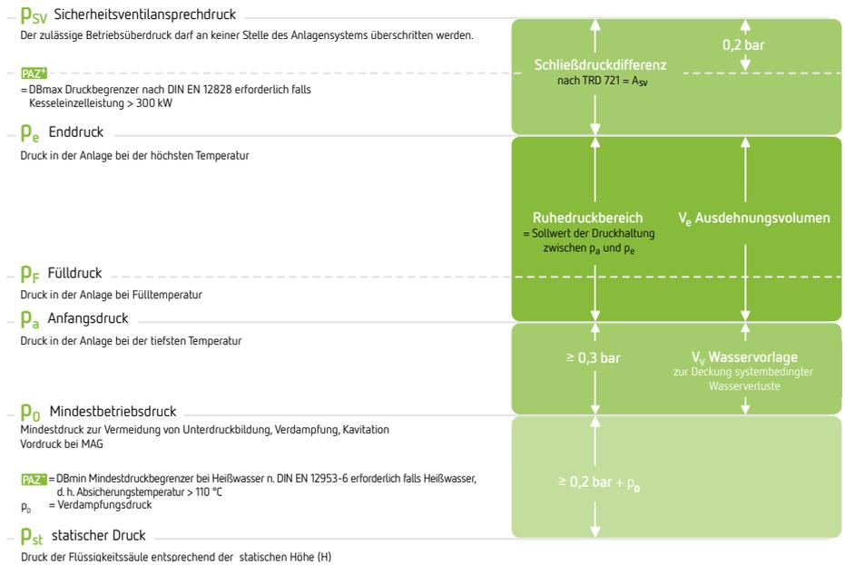
Drücke werden als Überdrücke angegeben und beziehen sich auf den Anschlussstutzen des MAG bzw. den Druckmessfühler bei Druckhaltestationen.
