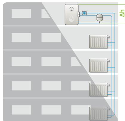
$$\text{z.B. bei } \Delta h = 3 \text{ m} \rightarrow p_{st} \approx 0,3 \text{ bar/Ü}$$
